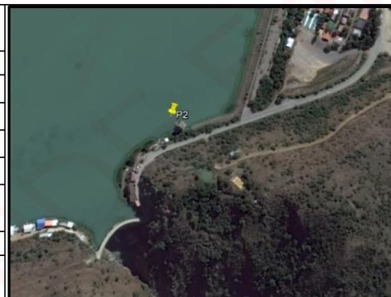
Este punto es en la toma de agua que va para riego y para generación de energía eléctrica, de acuerdo a la clasificación de la LMA 1333 el agua en este punto es de "CLASE B" según su aptitud de uso, el parámetro que lo convierte de este tipo son los Coliformes fecales con un valor de 78 NMP/100ml.
